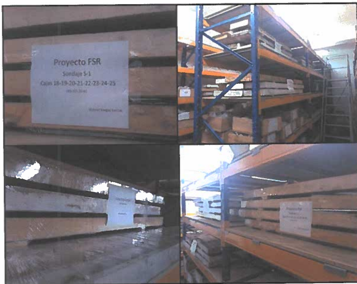
Figura 6.12. Fotografías de la ubicación final de los testigos del sondaje S-1.
