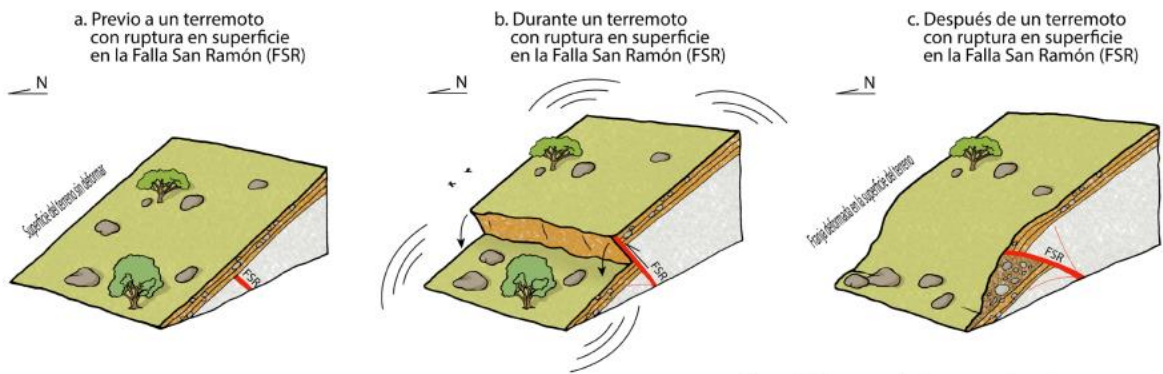
Figura 3. Esquema del proceso de ruptura en superficie como producto de un terremoto cortical de gran magnitud (Mw7,2-7,5), deducido a partir de observaciones de campo a lo largo de la traza de la Falla San Ramón.
