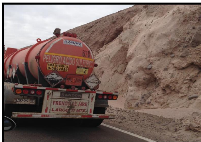
Figura 7. Nombre del material peligroso impreso en el contenedor.
