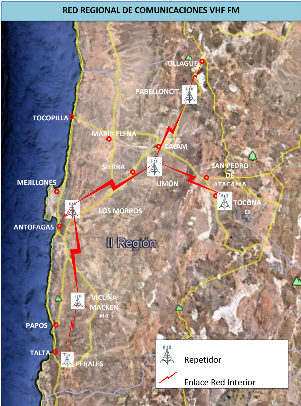
Figura N° 7: Enlace de Telecomunicaciones Regional VHF
