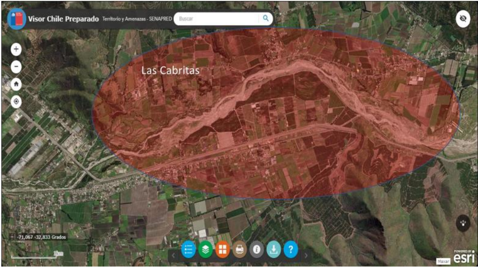
Imagen 7: Sector Las Cabritas, rio Aconcagua sin defensa fluvial, peligro desborde, involucrando al pueblo.
