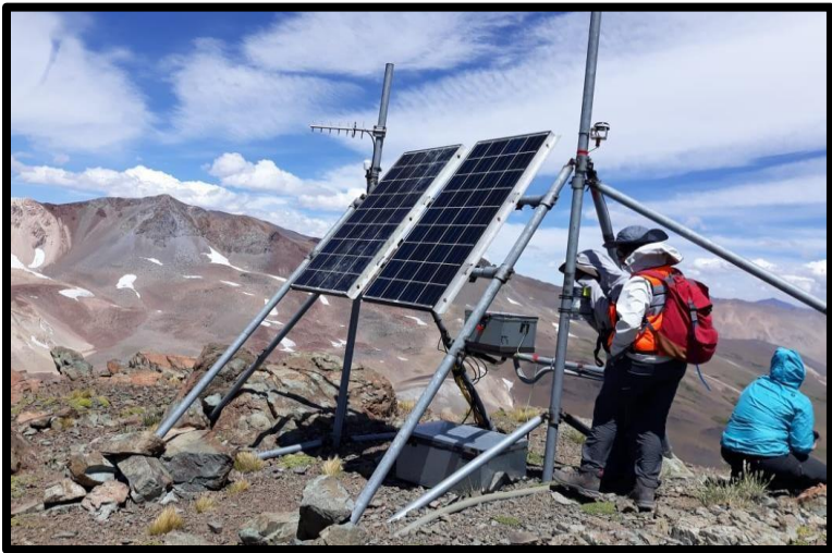
Cenizometro instalado por Observatorio Vulcanológico de los Andes del Sur OVDAS, organismo dependiente de SERNAGEOMIN, a 2850 msnm
