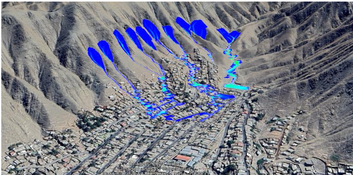
Figura 4. Imagen aérea de la Población Cartavio orientada hacia el norte. La modelación en color azul refleja potencialmente el área de generación y circulación de flujos aluvionales bajo la amenaza hidrometeorológica con la presencia de la obra hidráulica (piscina aluvional). (DESE, 2021).
