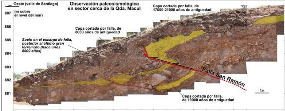
Figura N°9. Fotomosaico de una trinchera o excavación realizada para estudios paleo sismológicos en el sector oriente de Santiago, cerca de la quebrada de Macul
