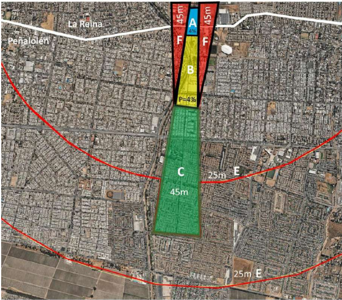
FIGURA 2-4: Esquema de limitantes de altura máxima
