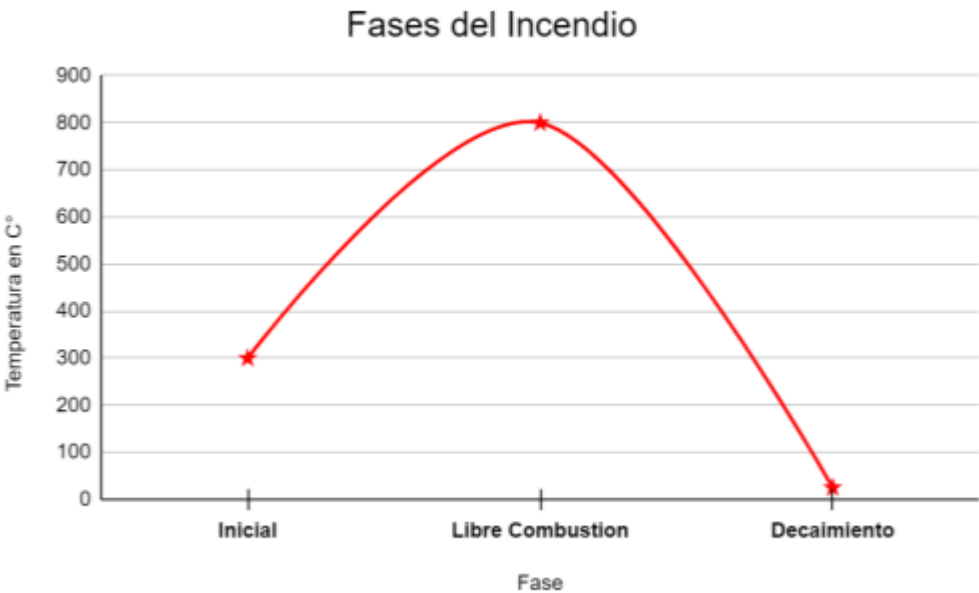
Figura N°1: Grafico de Fases del Incendio Estructural.
