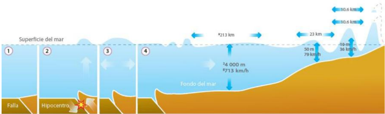
Imagen N°2: Proceso de Generación de un Tsunami.
