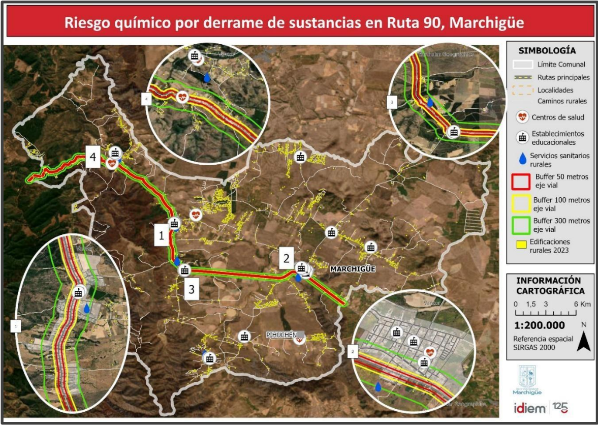
Figura 17: Riesgo químico por derrame de sustancias en ruta 90, Marchigüe.
