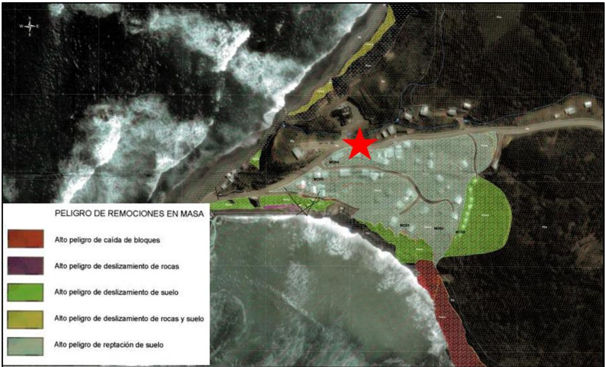
Figura N° 7: Mapa de peligros por remoción en masa elaborado por Duhart y otros (2009). Fuente: Observaciones de Remoción en Masa que Afecta la Ruta de Acceso a Caleta Estaquilla (v-626), Comuna de Los Muermos, Región de los Lagos, SERNAGEOMIN 2024.
