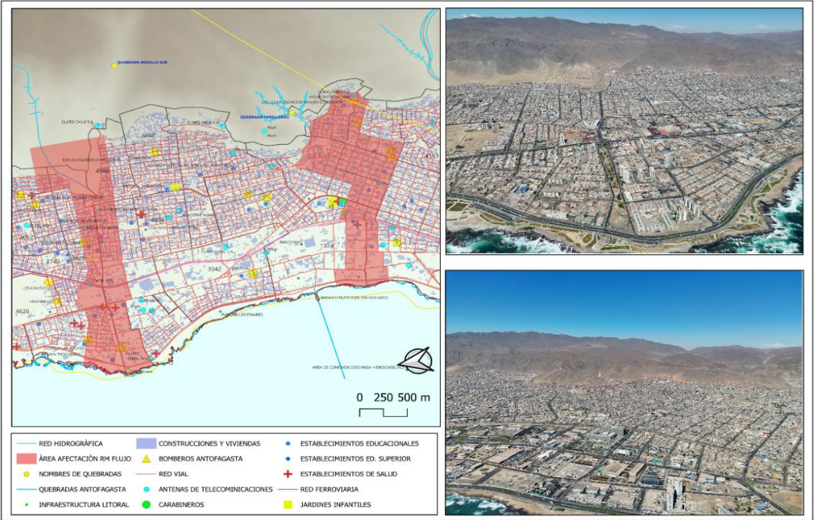
Figura 9: Zonificación de áreas expuestas a remoción en masa por flujo (aluvión) asociada a la actividad de quebradas. Capas del Visor Chile Preparado e imágenes aéreas obtenidas mediante dron. I. Municipalidad de Antofagasta, 2026.
