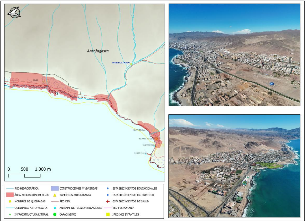
Figura 13: Zonificación de áreas susceptibles a remoción en masa por flujo (aluvión) asociada a la actividad de quebradas. Capas del Visor Chile Preparado e imágenes aéreas vía dron. I. Municipalidad de Antofagasta, 2026.
