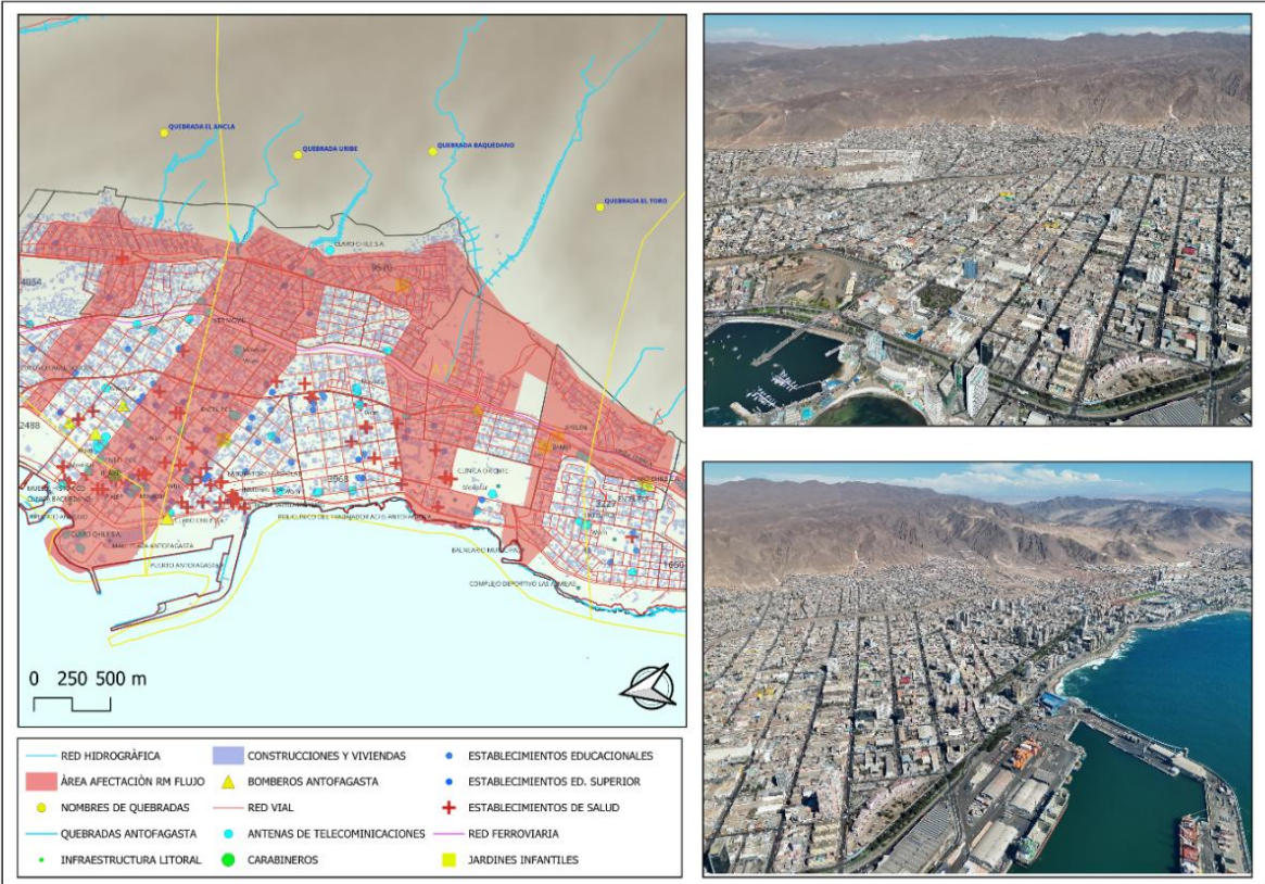
Figura 11: Zonificación de áreas susceptibles a remoción en masa por flujo (aluvión) asociada a la actividad de quebradas. Capas del Visor Chile Preparado e imágenes aéreas obtenidas mediante dron. I. Municipalidad de Antofagasta, 2026.
